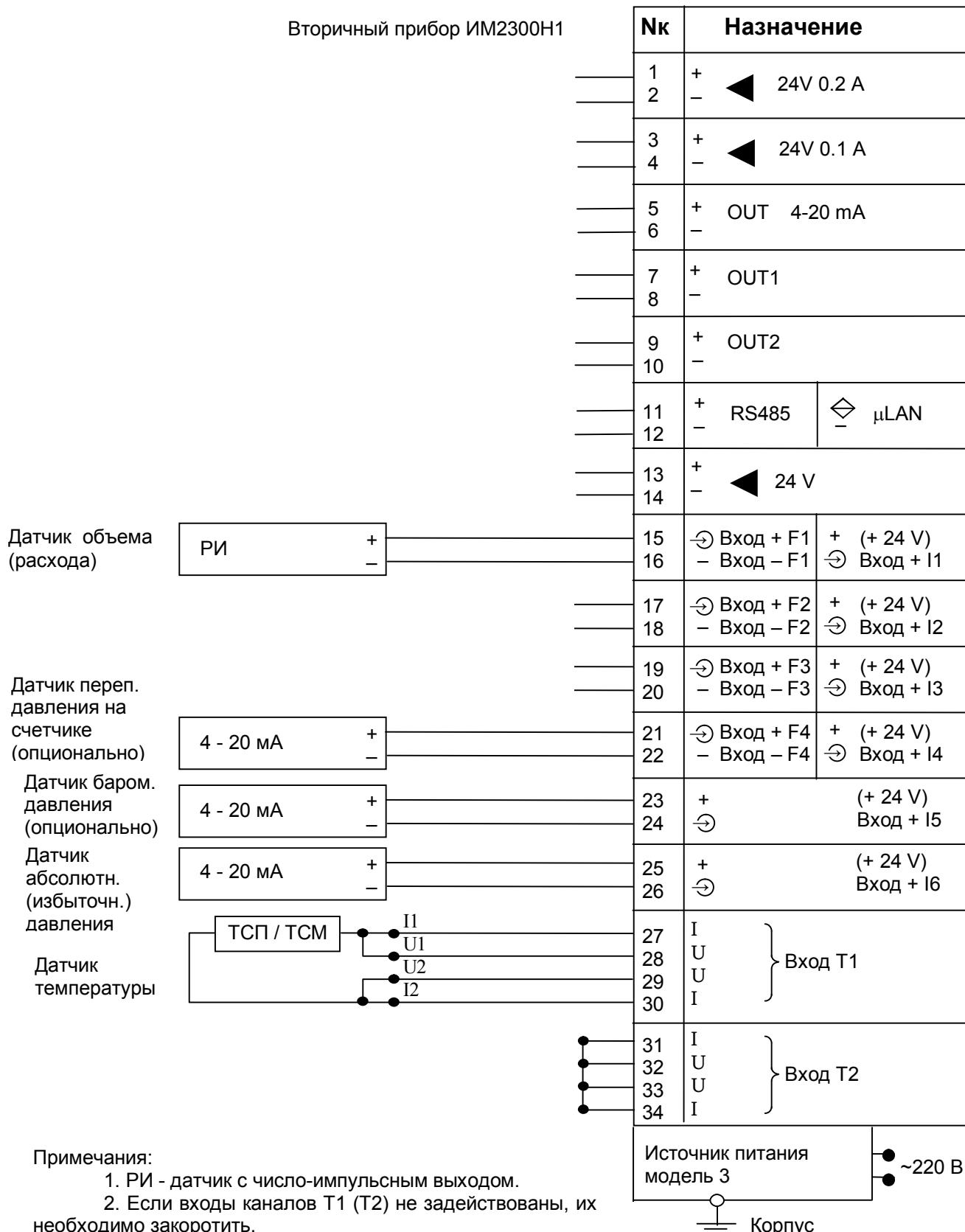
Пример схемы подключения датчиков к вычислителю ИМ2300ЩМ1 (2 узла)
