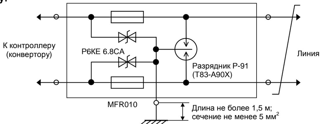
Устройство грозозащиты и подавления импульсных помех ИМ2314 (выпускается серийно).
