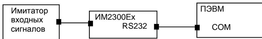
! соединение производить при выключенном питании прибора и ПЭВМ
