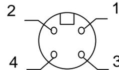
На кабельной части разъема соединить контакты 1 и 2.
