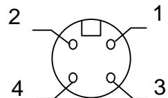
На кабельной части разъема соединить контакты 1 и 2.
