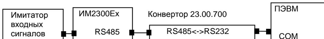
При подключении конвертора RS232-RS485 использовать его инструкцию по эксплуатации.
